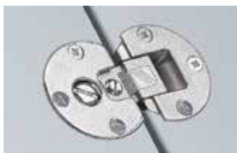
Петля для откидных элементов Markant 11 регулируется по высоте, глубине и имеет боковую регулировку. Это гарантирует максимально точное позиционирование откидных элементов.
