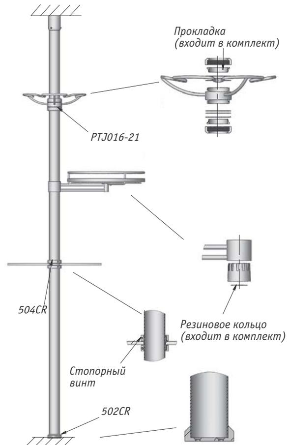
Барная труба диаметр 50 мм
