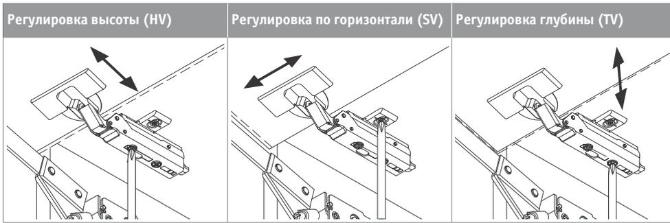
**Возможности регулировки промежуточных петель**
